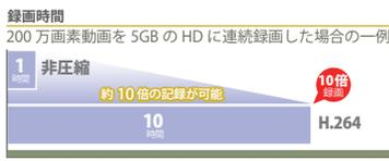
ハードウェア圧縮でリアルタイムの高解像度ストリーミングが可能 H.264 では、従来のメガピクセルカメラにくらべ同じ保存容量で10倍の録画時間が可能になります。
